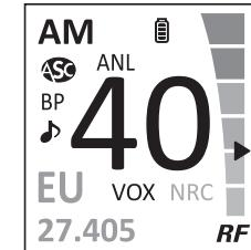
Die 6-stufige BALKENGRAFIK rechts zeigt den rel. Empfangspegel (RX) bzw. rel. Ausgangsleistung (TX) an.
