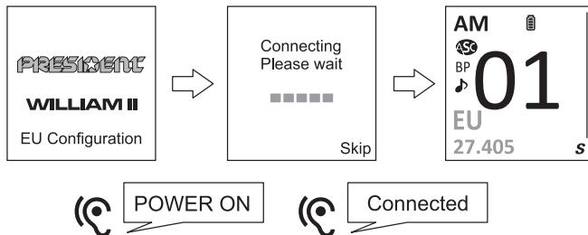
Sobald sich das **Grundgerät** über den **Bluetooth-Dongle** (13) mit dem **drahtlosen Bedienteil mit Mikrofon und Lautsprecher** erfolgreich verbunden hat, wird die akustische Meldung „Connectet“ („Verbunden“) über den Lautsprecher ausgegeben.
